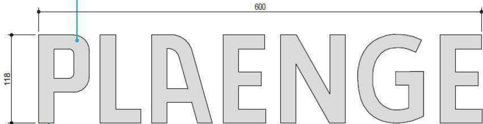
CAIXA LATERAL EM AÇO INOX COM ILUMINAÇÃO EM LED
